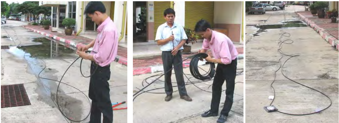
ภาพประกอบที่ 3.33 ทดสอบคลี่ Loop เพื่อดูค่า Friction ระหว่างเส้น Fiber กับ Loose Tube
