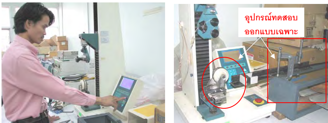
ภาพประกอบที่ 3.26 ทดสอบ ค่า Friction ระหว่างเส้น Fiber กับ Tube
