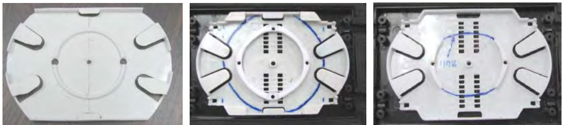
ภาพประกอบที่ 4.17 อาคารรองรับเส้น Fiber ต้นแบบ ที่มีสัณฐานวงกลมและวงรีที่กำหนด
