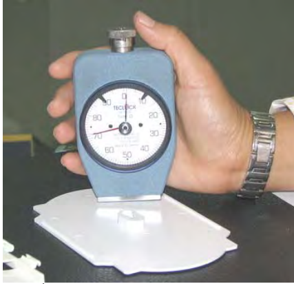
ภาพประกอบที่ ค.1 ทดสอบ Hardness มาตรฐานรับเส้น Fiber
