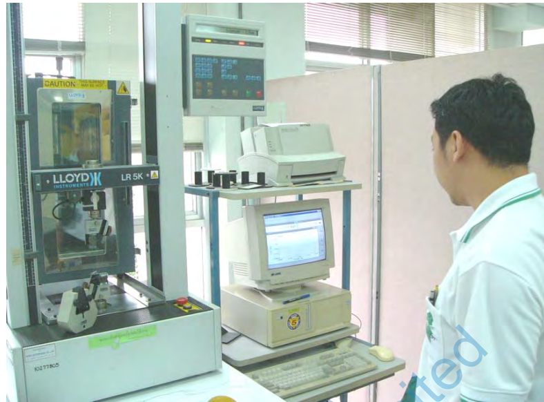
ภาพประกอบที่ 3.22 ทดสอบแรงดึง (Tensile) ของ Steel Wire และ Bare Fiber
