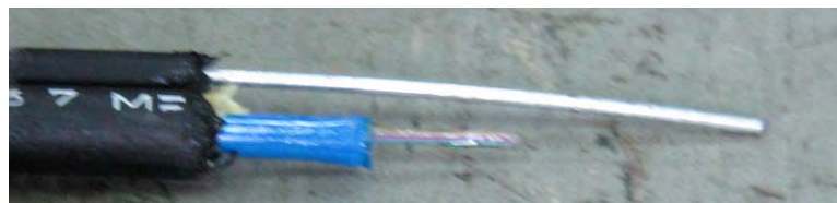
ภาพประกอบที่ 3.9 โครงสร้างสาย Optical Drop Cable
