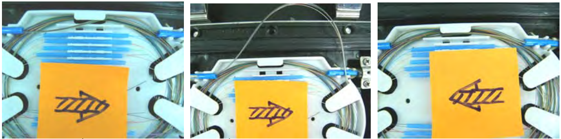
ภาพประกอบที่ 4.9 จำลองเส้น Fiber เคลื่อนตัวในถาดรองรับเส้น Fiber ในทิศทางต่าง ๆ
