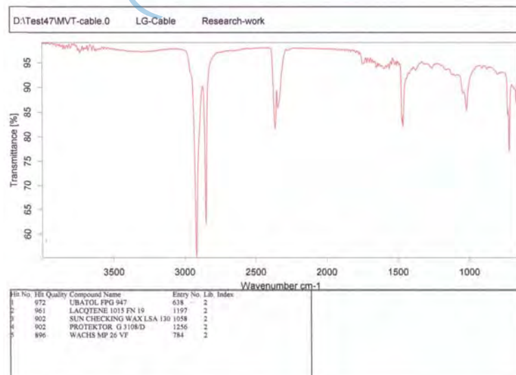
ภาพประกอบที่ 3.13 Peak ที่ทดสอบจากเครื่อง FT-IR
