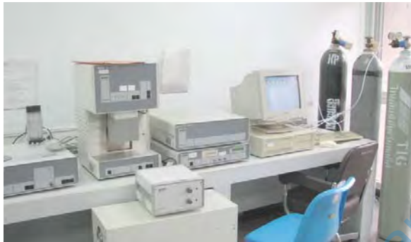
ภาพประกอบที่ 3.11 เครื่องมือวิเคราะห์ Thermal Analysis และ X-ray Fluorescence Analysis
