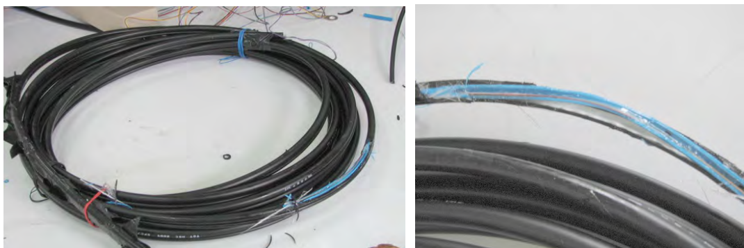
ภาพประกอบที่ 3.30 กริด Cable Sheath ดูลักษณะเส้น Fiber ภายใน Loose Tuber
