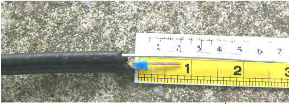
ภาพประกอบที่ 3.32 แสดงเส้น Fiber, Steel Wire และ Loose Tube เคลื่อนตัว
