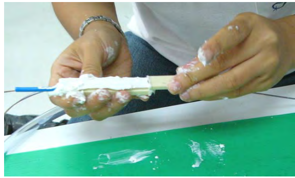
ภาพประกอบที่ 4.5 เตรียมตัวอย่างเพื่อทดสอบการเกาะยึดของซิลิโคนและสาร SISTA กับเส้น Fiber
